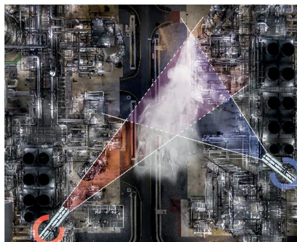
Sensoren identifizieren Gasmoleküle, analysieren die chemische Zusammensetzung und bestimmen so Ort und Konzentration einer Gaswolke. Abbildung: Grandperspective
